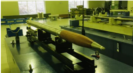
รูปที่ 2 การวัดค่าคุณสมบัติทางกลของจรวด 122 มม.
