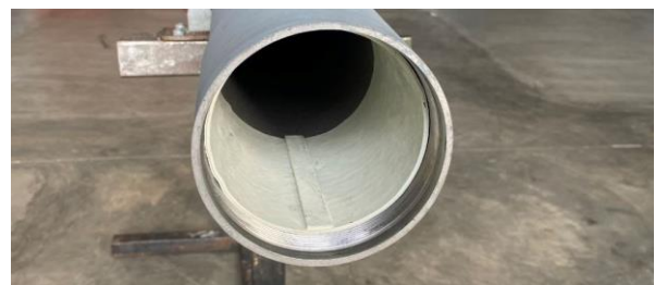
รูปที่ 2 ลักษณะของฉนวนยางกันความร้อนในท่อมอเตอร์จรวด
