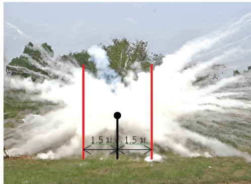
รูปที่ 8 ผลการทดสอบภาคสนามของเครื่องดับเพลิงภาชนะวัสดุกระดาษคราฟต์
