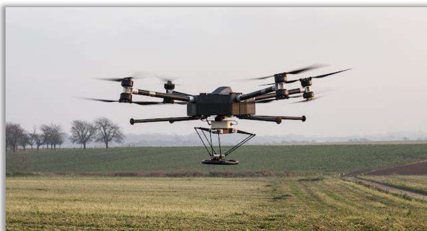
ตัวอย่างรูปภาพ อากาศยานไร้คนขับติดตั้งอุปกรณ์ตรวจจับทุ่นระเบิด (ที่มาของภาพ : Mine Kafor)
