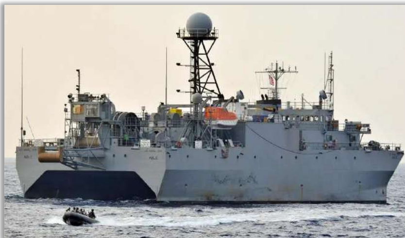
รูปภาพ เรือสำรวจทางทะเลชั้น Victorious ของกองทัพเรือสหรัฐอเมริกา ที่มีการติดตั้งระบบโซนาร์ลากท้าย Surveillance Towed Array Sensor System Expeditionary (ที่มาของภาพ : The Defense Post)
