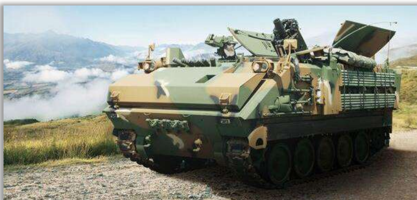
ตัวอย่างรูปภาพ เครื่องยิงลูกระเบิดขนาด 120 มิลลิเมตร ติดตั้งบนรถ M113 (ที่มาของภาพ : Hanwha Defense)
