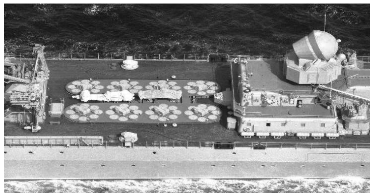
รูปที่ 3 สล๊อตยิงอาวุธนำวิถีต่อสู้อากาศยานของเรือชั้น Moskva (ที่มา Wikipedia.org)
